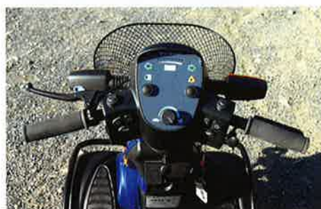
Übersichtlich: Blinker und Hupe sind beidseitig bedienbar, Gas und Bremse beim Serienmodell bisher leider nur auf einer Seite
