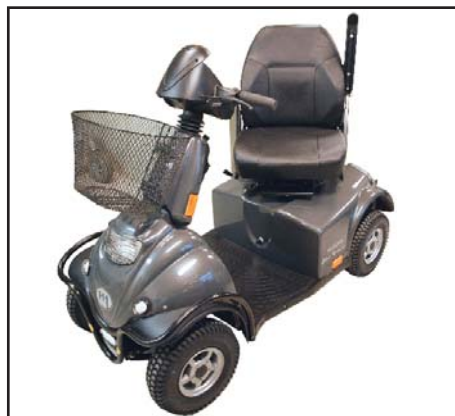
Mini Crosser ausschalten, Lenksäule nach vorne schieben, Sitz drehen und Armlehne hochklappen.
