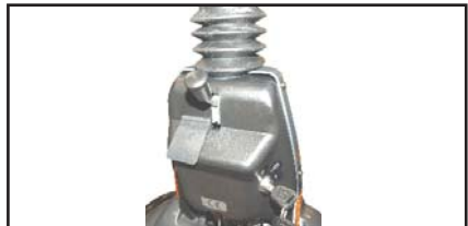
Der Ladestecker wird an die 3-polige Ladebuchse an der Lenksäule angeschlossen. Die Ladebuchse befindet sich unter der Schutzklappe.
