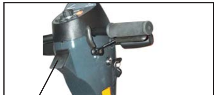
Der Ladestecker wird an die 3-polige Ladebuchse an der Lenksäule angeschlossen. Die Ladebuchse befindet sich unter der Schutzklappe.
