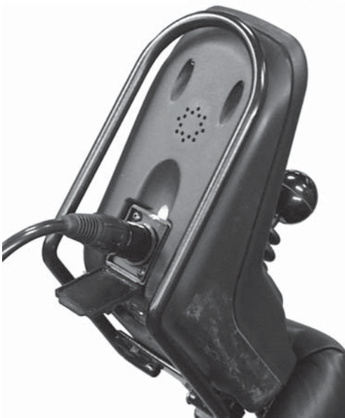
Abb 16 Der Ladestecker wird an die 3-polige Ladebuchse an der Lenksäule angeschlossen. Die weiße Markierung muss nach oben zeigen. Die Ladebuchse befindet sich unter der Schutzklappe.
