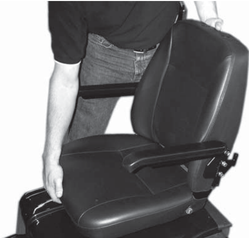
Abb 7 Sitz aus dem Sitzrohr herausziehen
