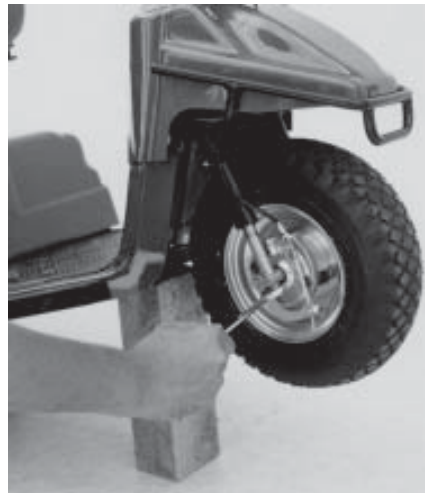
Abb. 15 Schrauben an beiden Seiten des Rades lösen und abnehmen.
