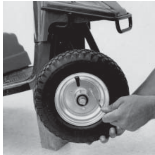
Abb. 17 Die drei Schrauben herausdrehen. Das Rad kann jetzt ausgewechselt werden.
