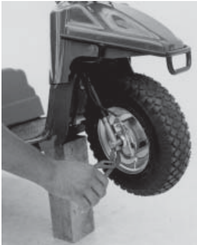
Abb. 14 Schrauben an beiden Seiten entsichern. Dazu das Sicherungsblech in die waagerechte Stellung richten.
