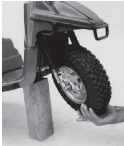
Abb. 16 Das Rad kann jetzt abgenommen werden.
