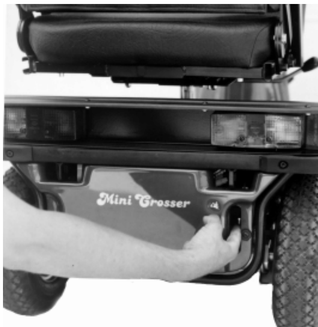
Abb. 21 Drücken Sie den Freilaufhebel nach unten. Jetzt kann das Fahrzeug geschoben werden. Drücken Sie den Hebel nach oben, um den Motor zu aktivieren (Standardstellung). Der Hebel darf nur in der unteren Stellung sein, wenn der Mini Crosser geschoben werden soll. Anschließend muss der Hebel wieder nach oben geführt werden. Jetzt wird das Fahrzeug gebremst und kann normal fahren.
