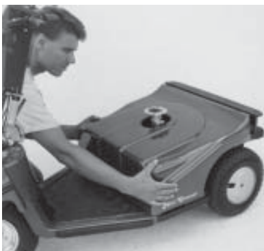
Abb. 5 Abdeckung nach vorne zum Lenker hin ziehen und dann abheben.
