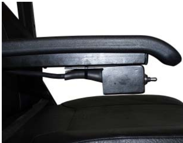
Abb. 8 Elektrische Sitzhöhenverstellung. Schalter nach oben = Sitz fährt hoch. Schalter nach unten = Sitz fährt herab.
