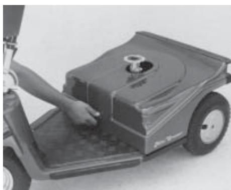
Abb. 4 Fingerschraube an der Vorderseite der Rückabdeckung gegen den Uhrzeigersinn drehen und abnehmen.
