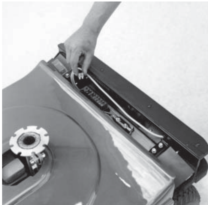
Abb. 19 Rückabdeckung lösen. Der Kunststoffdeckel lässt sich abnehmen, indem man auf die Seiten drückt. Jetzt können die Sicherungen ausgewechselt werden.
